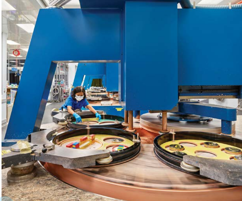
艾司摩爾用這些拋光機研磨零組件，再裝進EUV曝光機。拋光過程分成好幾個階段，一個零組件可能要花上數週時間拋光，技術人員會檢驗平滑程度，達到奈米級的精準度。
