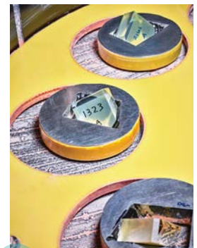
進一步細看拋光機。圖中的玻璃塊以特定角度放置，藉此達到正確的斜角。
