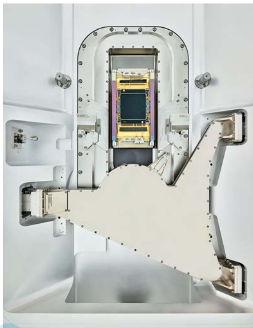
玻璃夾鉗（圖中上的黑色長方形）夾住光罩；光罩上的圖案會轉印到晶圓。
