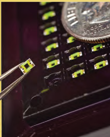
碲化鎢是每一個電池中的黑色方塊部分。只用少量的昂貴材料，可以壓低成本。(左)
