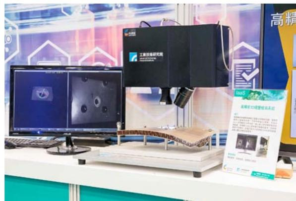
高精密3D視覺檢測系統，以電腦視覺技術檢測工件外型，並可視檢測結果調整參數。
