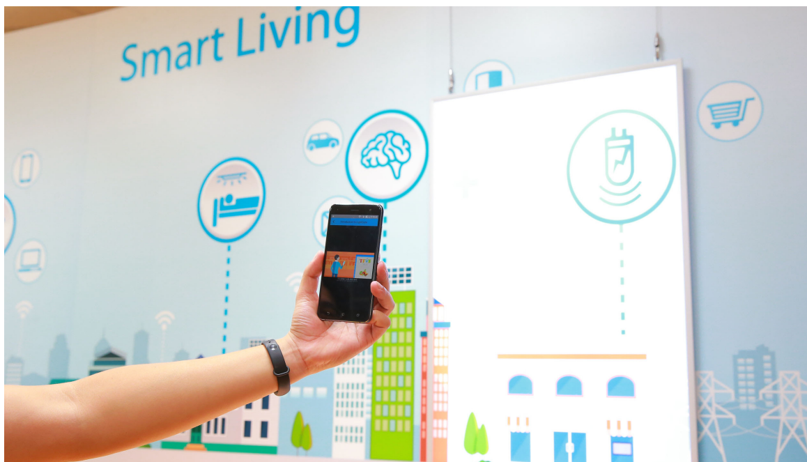
「OCC光碼互動服務系統」利用LED閃爍的特性傳遞光源訊號，可應用在導覽、解說服務方面。
