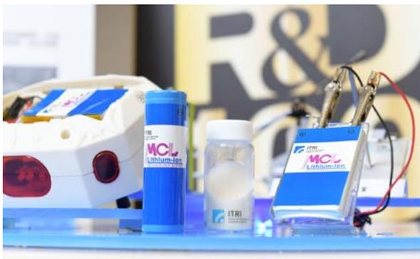
NAEPE固化時呈現網狀結構，可增加硬體結構強度，當鋰電池受衝擊時不易損壞，且電解液具有阻燃性，安全性大大提升。
