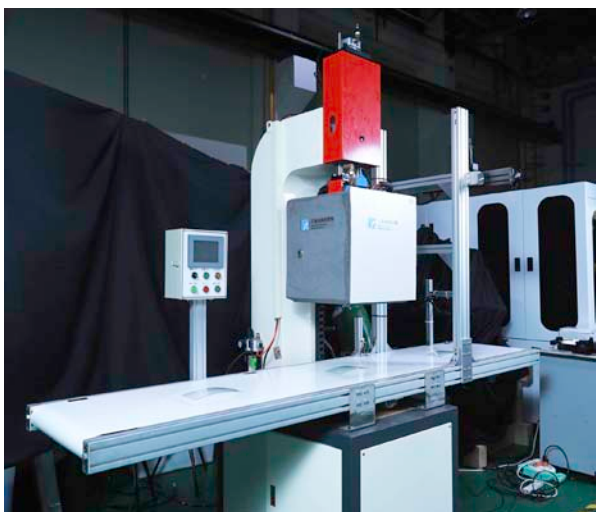
這項技術不僅能讓工件表面霧化時間降為10秒，將視覺感測範圍從反射率20%~80%延伸為10%~99%反射率，擴大工件檢測範圍。
