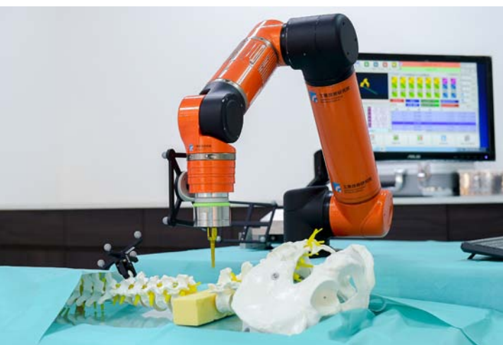
工研院整合醫療導航系統與機械手臂，協助醫師精準執行手術，減少誤差。
