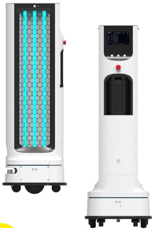
因應當前疫情需求，LG主打「CLOi UVC Robot」，可自行偵測環境，以紫外線進行消毒。（圖為機器人正反面，LG提供）
