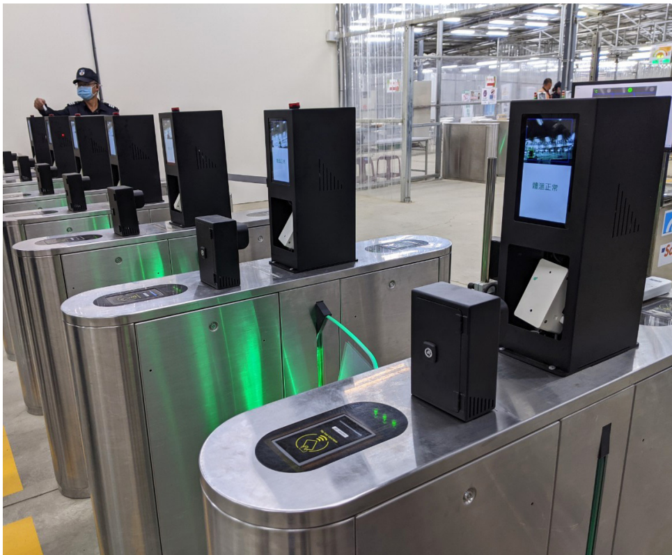
工研院已客製化協助台積電將體溫偵測技術結合個人身份資料，整併至新竹新建廠工地的員工門禁管理系統。
