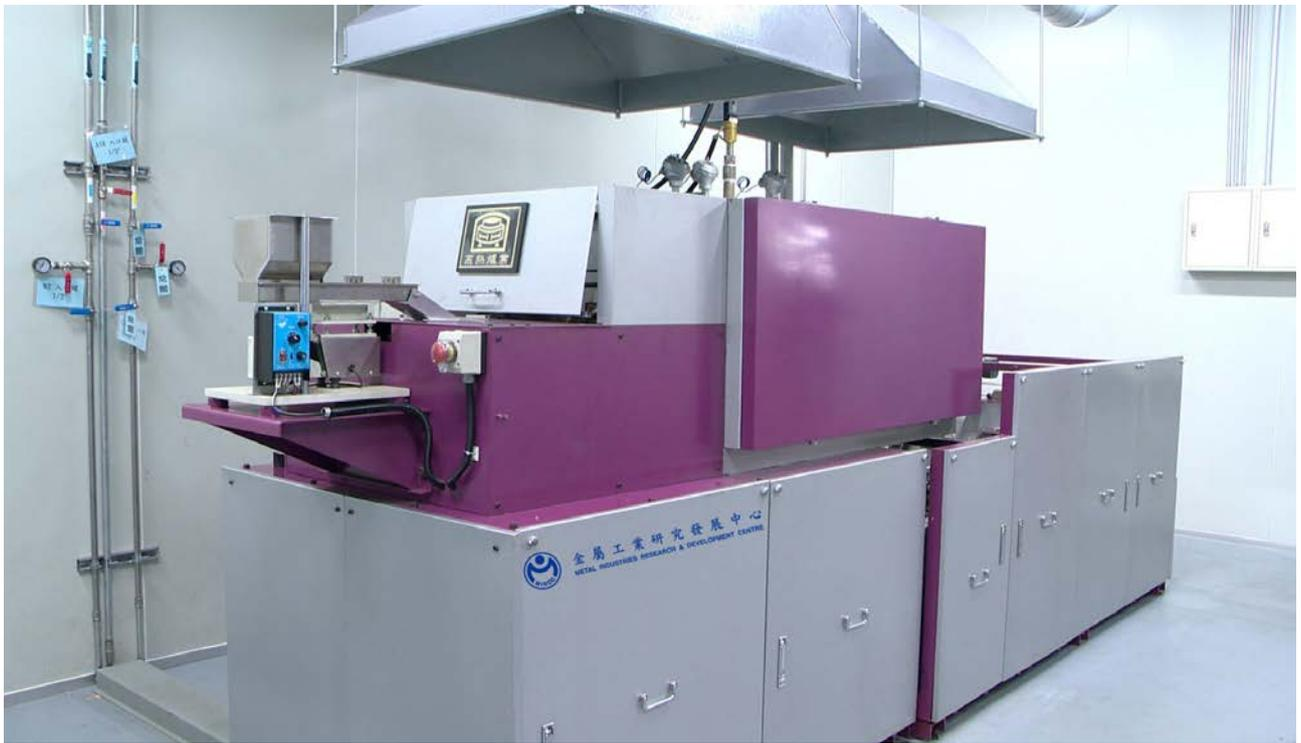
金屬中心研發「精微金屬零組件熱處理技術暨設備」，可均勻處理小如指甲、細如髮絲的微型零組件，大幅提升微型零件熱處理良率。
